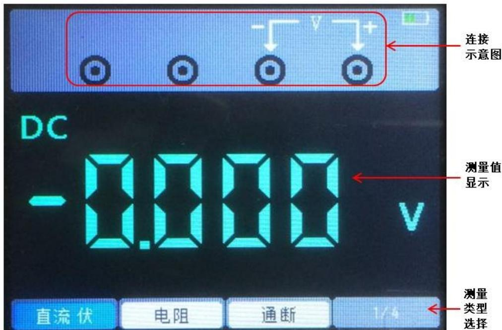
万用表测量类型包括直流电压（V、mV）、交流电压、直流电流（A、mA）、交流电流（A、mA）、电阻、电容、二极管、通断测试。
