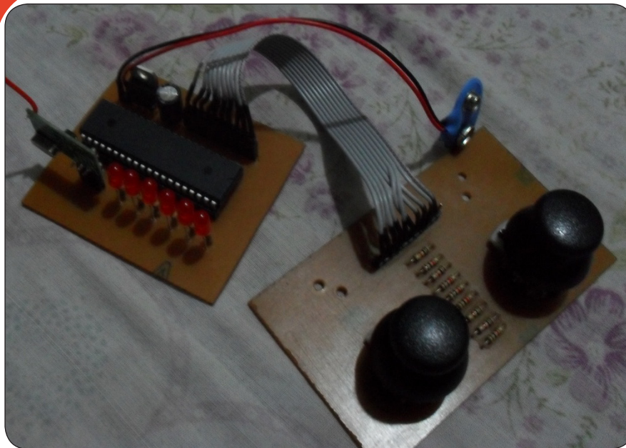
شکل شماره ۲۲: مدار فرستنده هلیکوپتر مدل
